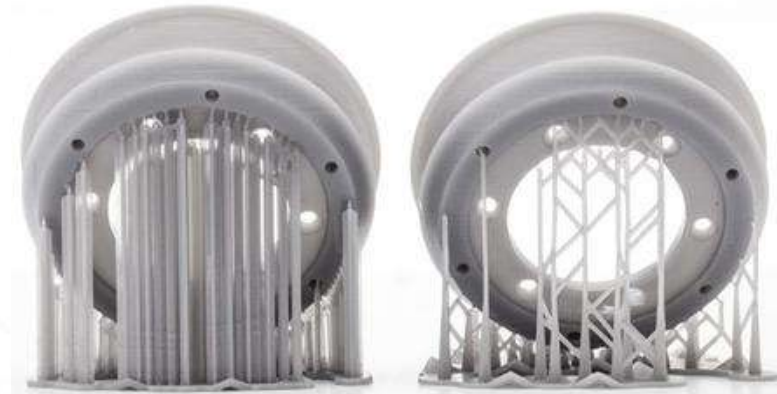
Stânga: Structuri de susținere de jos în sus Dreapta: Structuri de susținere de sus în jos
